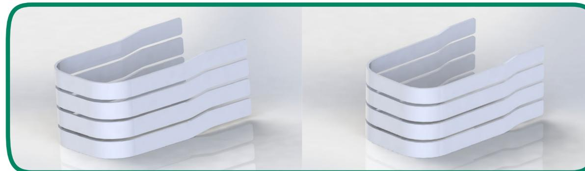
Stabilisierung durch Formüberlagerung an den Seiten
